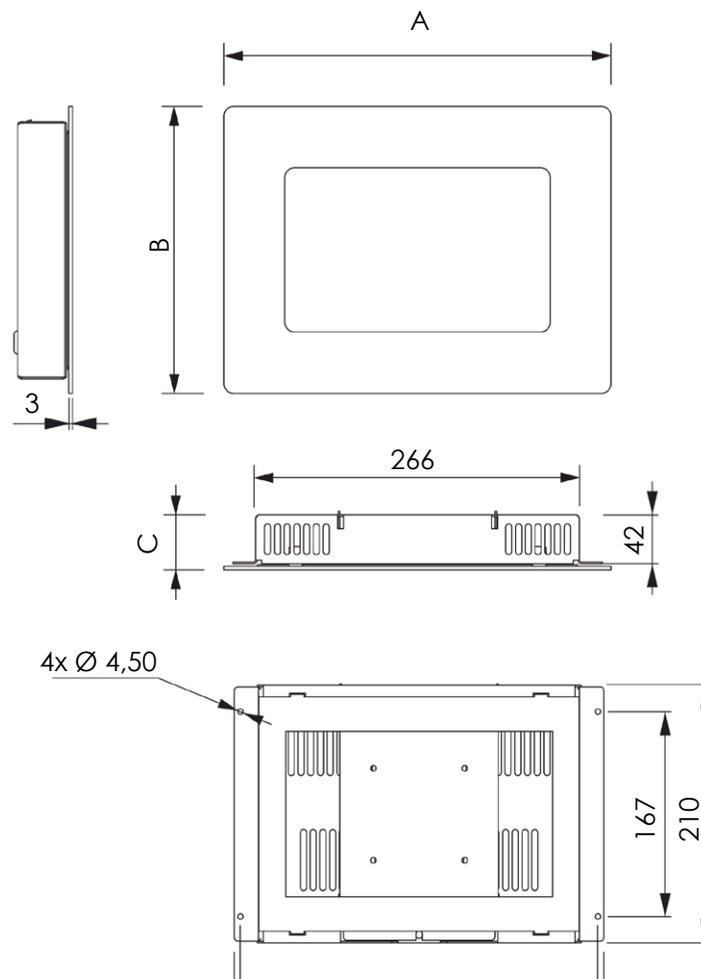
Schermo professionale ad incasso. Variante NO-Touch: il tablet è completamente coperto da un riquadro di vetro e quindi lo schermo non è accessibile per il tocco. Variante Touch: il tablet è circondato da una cornice che ne copre i bordi e lascia lo schermo accessibile per il tocco. Misura standard del tablet 10", altre misure su richiesta. Nero è il colore standard, bianco e altri colori RAL sono disponibili su richiesta.
