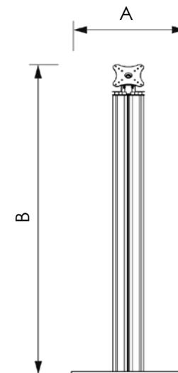
Espositore porta monitor autoportante. La struttura permette la regolazione del monitor. Lo speciale montante di sicurezza è formato da un profilo curvo in grado di contenere il cavo di alimentazione. La base è in acciaio con copertura in alluminio silver. Monitor non incluso.
